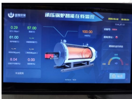
图 5.38 锅炉能效在线监测系统
